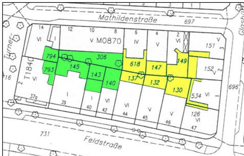
**Abbildung 3.2-13: Lageplan Modell 3 Versickerungsanlage des getrennten Systems**
